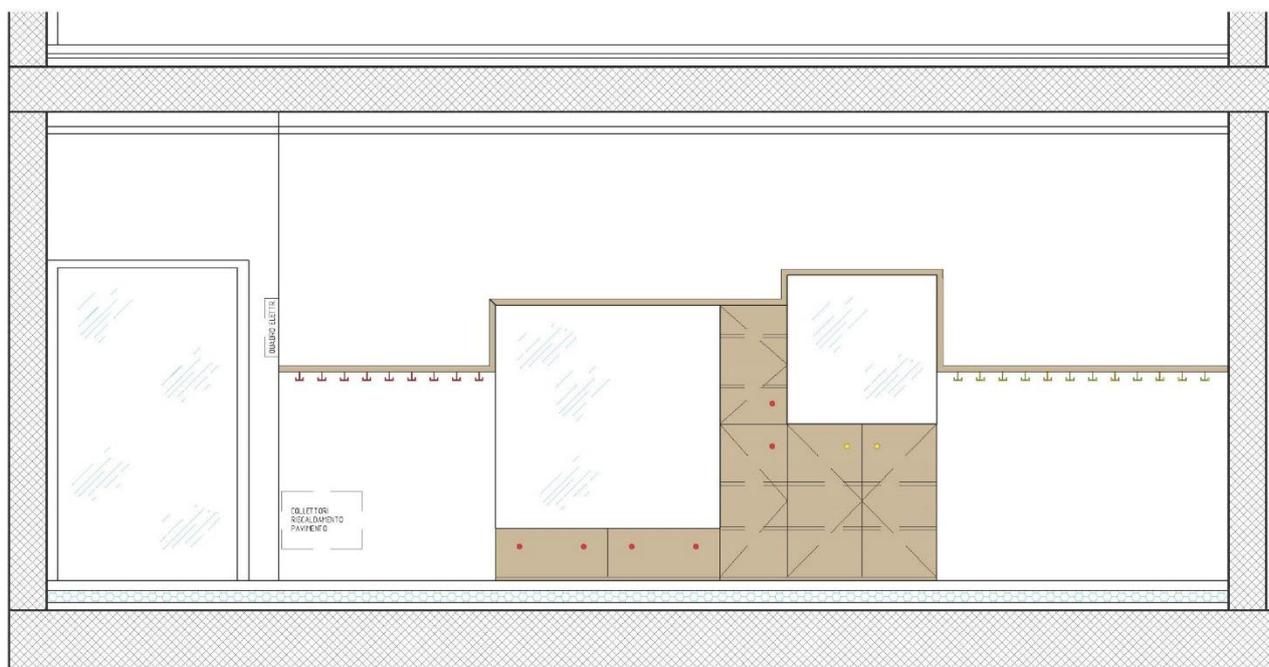
I mobili contenitori saranno di diverse misure a seconda delle esigenze didattiche e dello spazio a disposizione, per semplificare si sono definiti dei moduli che riportiamo di seguito.
